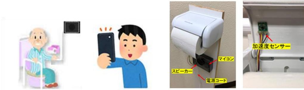
図1 開発した排便時の声かけシステム 図2 トイレトペーパーの引き出し検出
